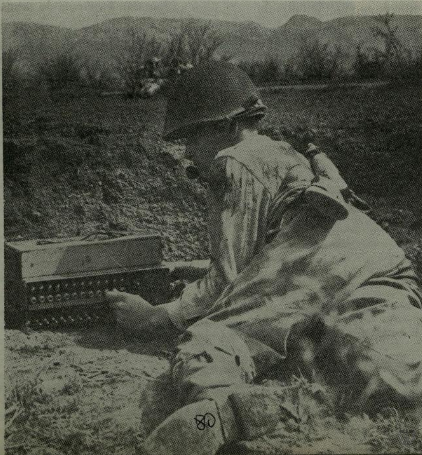
Instalación y manejo en el terreno de un cuadro conmutador telefónico, por un Alférez de Telecomunicaciones.
